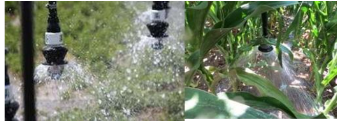
Figura 29. Novo emissor Quad Spray simplificado para duas funções: bulbo cheio e área total.
