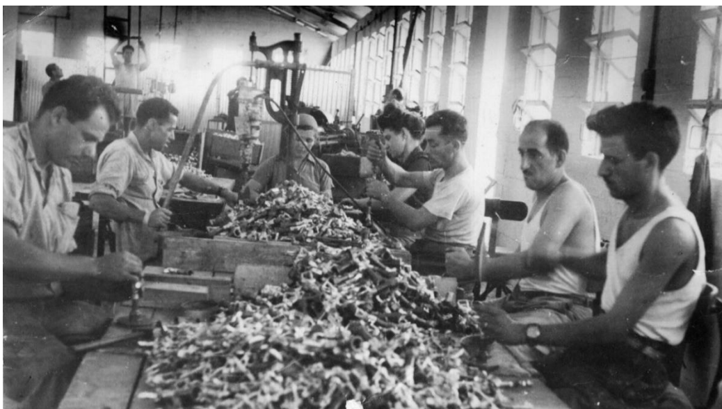
Figura 1. Montagem de aspersores metálicos na fábrica situada no kibutz Naan, Israel, fundada no ano de 1937.
