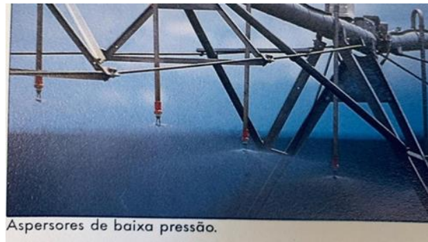
Figura 4. Reguladores pressão Valmatic de 14, 21 e 4,2 mca (20, 30 e 6 psi).
