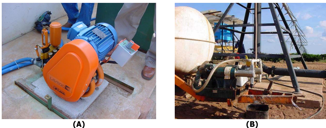
Figura 10. Sistema de fertirrigação utilizando bomba injetora de pistão (BASTOS, 2009).
