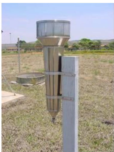
Figura 16. Pluviômetro para medição da precipitação.
