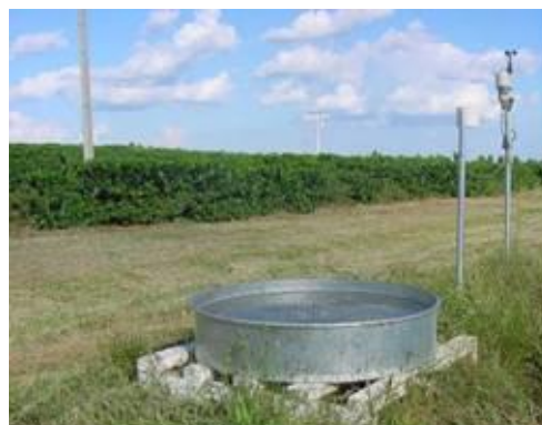
Figura 19. Tanque de evaporação tipo classe A.
