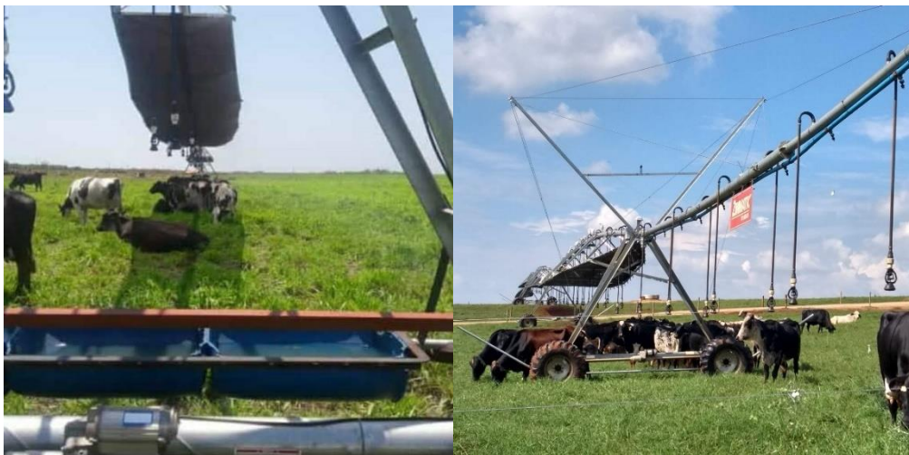
Figura 8. Bebedouros e tela sombrite instalados na estrutura de uma torre de pivô central (Senninger).
